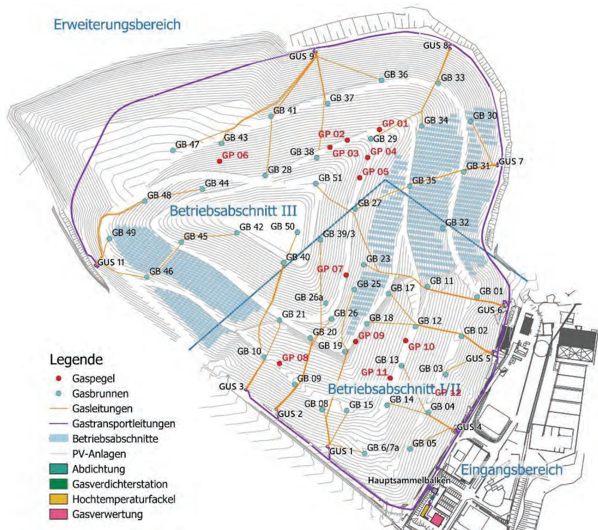
Abb. 2.1: Betriebsabschnitte und Gasfassungssystem der Deponie Brandholz (Stand 2023)
